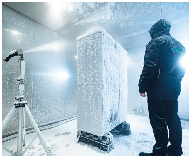
Los equipos de pruebas hacen trabajar a las unidades en condiciones climáticas extremas en las cámaras climáticas.
